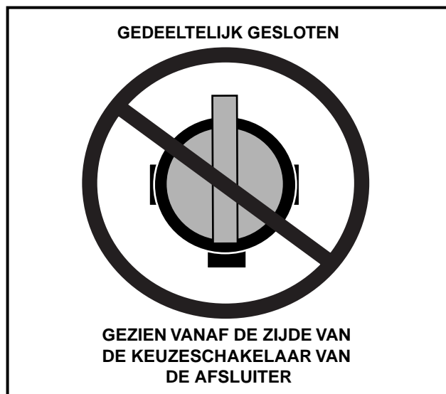
Figuur 12 Verkeerde afstelling van de brandstofafsluiter
