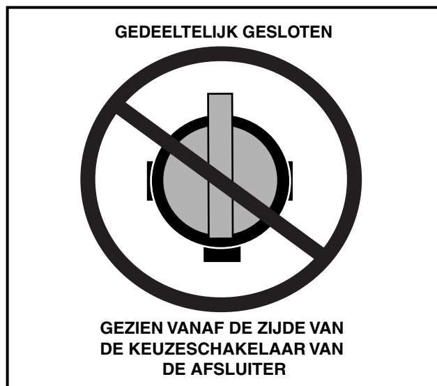
Figuur 12 Verkeerde afstelling van de brandstofafsluiter
