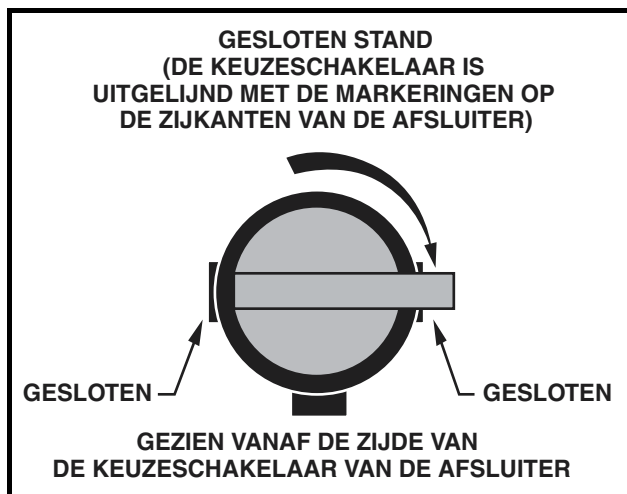
Figuur 21 Brandstofkraan – gesloten stand
