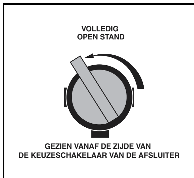
Figuur 22 Brandstofkraan – open stand
