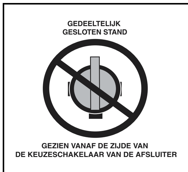
Figuur 23 Brandstofkraan – gedeeltelijk gesloten stand
