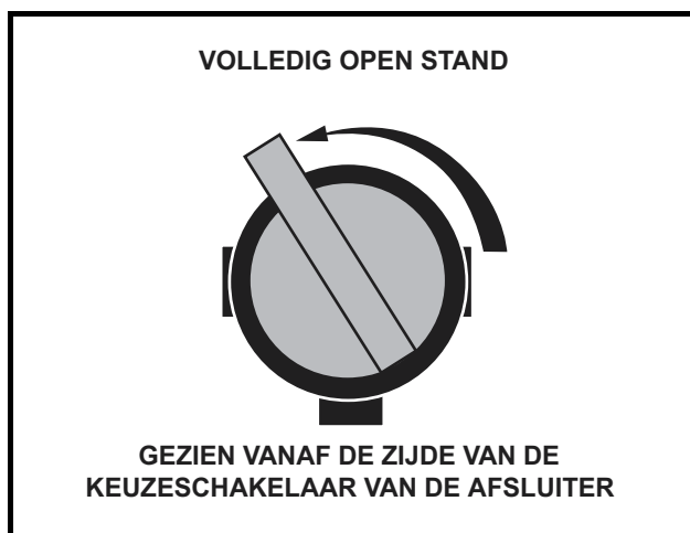
Figuur 23 Brandstofafsluiter – open stand
