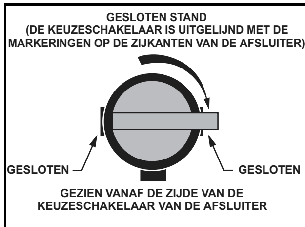
Figuur 22 Brandstofafsluiter – gesloten stand
