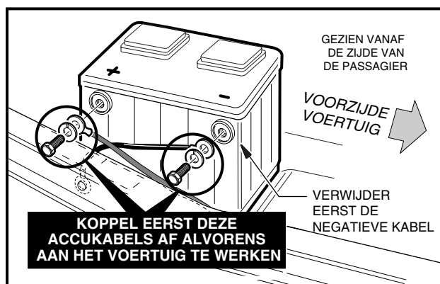
Figuur 1 Verwijderen van de accukabel
