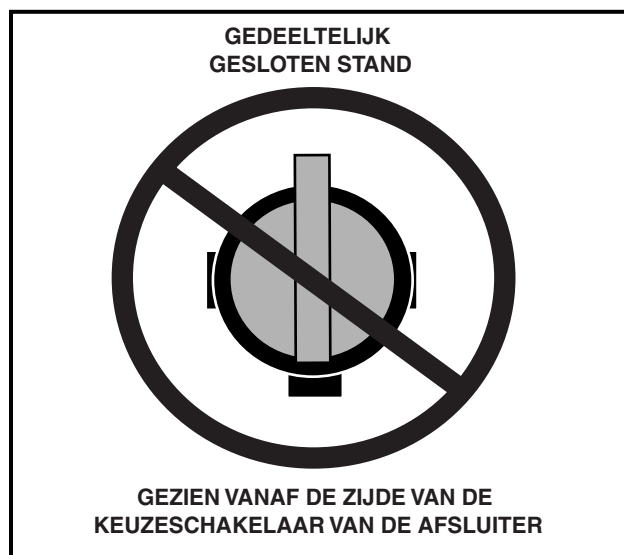
Figuur 12 Verkeerde afstelling van de brandstofafsluiter
