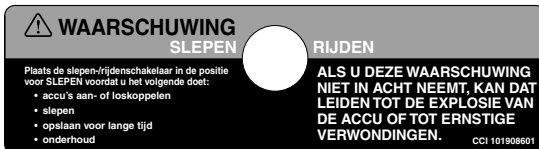
WAARSCHUWINGSSTICKER SLEEPSCHAKELAAR (OP DE BEUGEL VAN DE SLEEPSCHAKELAAR ONDER DE BANK)
