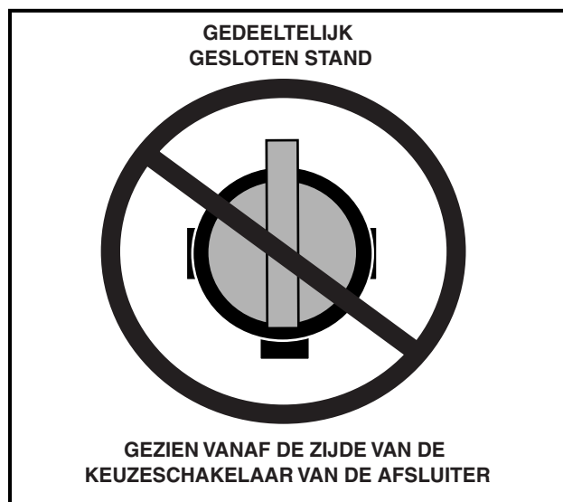
Figuur 12 Verkeerde afstelling van de brandstofafsluiter
