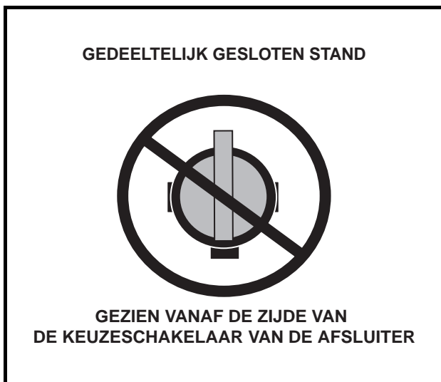
Figuur 14 Brandstofventiel – gedeeltelijk gesloten stand
