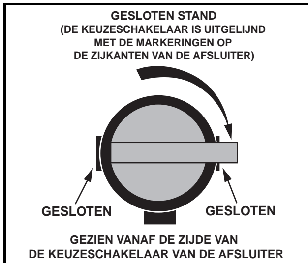
Figuur 12 Brandstofafsluiter – gesloten stand
