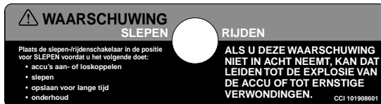
WAARSCHUWINGSSTICKER SLEPESCHAKELAAR (OP DE BEUGEL VAN DE SLEPESCHAKELAAR ONDER DE BANK)
