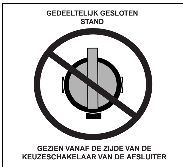
Figuur 16 Verkeerde afstelling van de brandstofafsluiter
