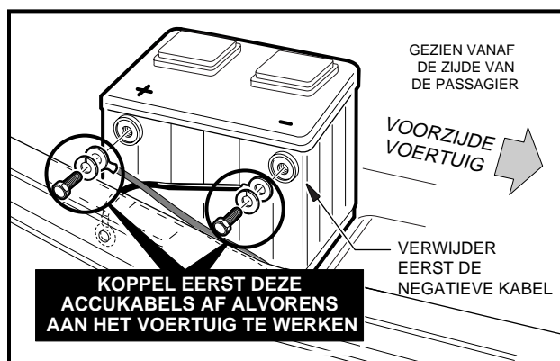
Figuur 1 Verwijderen van de accukabel
