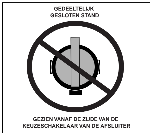
Figuur 12 Verkeerde afstelling van de brandstofafsluiter
