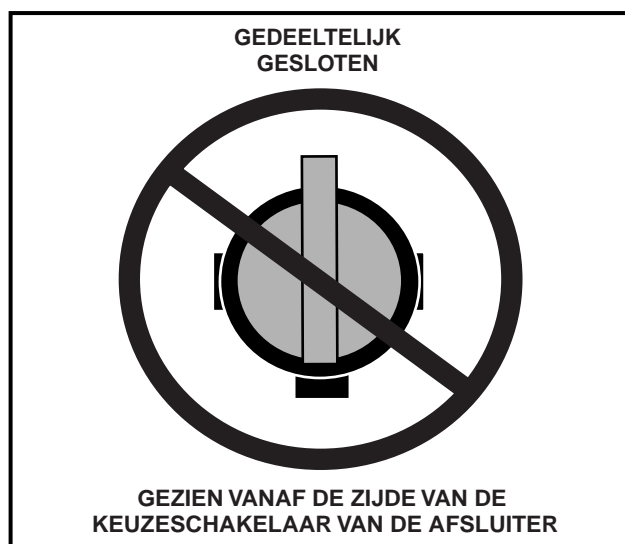
Figuur 18 Verkeerde afstelling van de brandstofafsluiter
