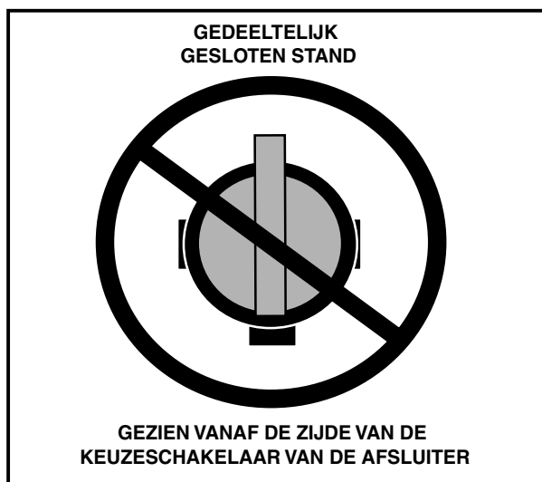
Figuur 12 Verkeerde afstelling van de brandstofafsluiter
