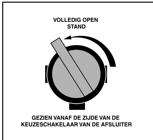
Figuur 11 Brandstofafsluiter – open stand
