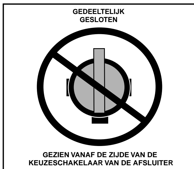
Figuur 18 Verkeerde afstelling van de brandstofafsluiter
