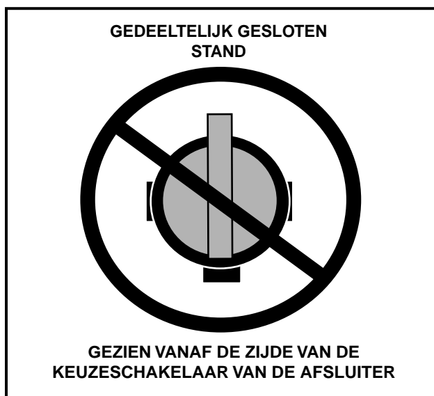
Figuur 16 Verkeerde afstelling van de brandstofafsluiter
