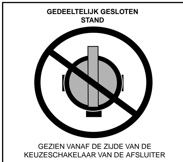
Figuur 16 Verkeerde afstelling van de brandstofafsluiter
