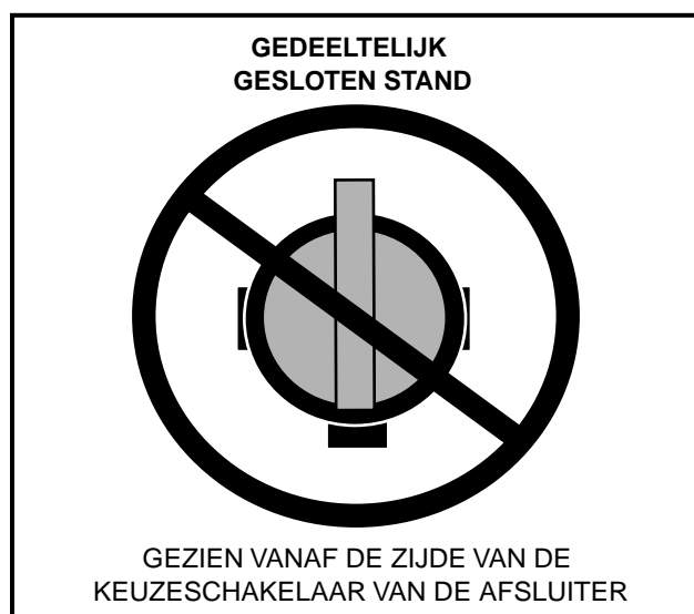
Figuur 20 Verkeerde afstelling van de brandstofafsluiter
