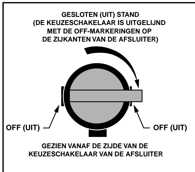
Figuur 18 Brandstofafsluiter – Gesloten stand
