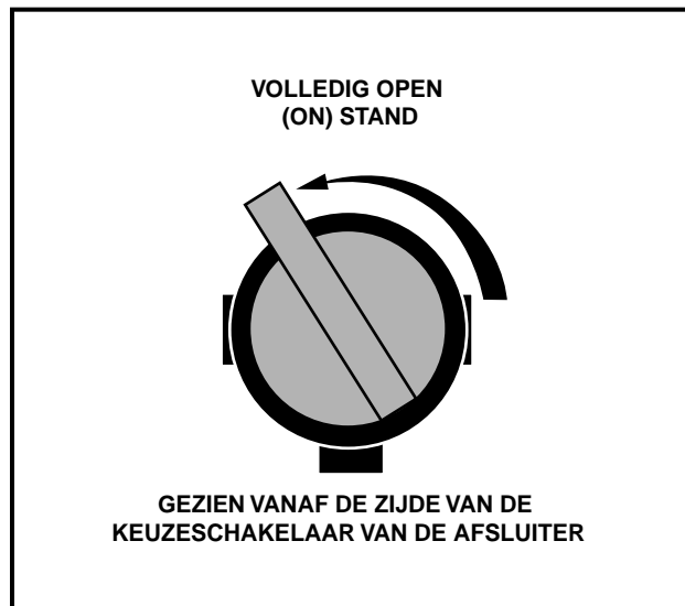
Figuur 19 Brandstofafsluiter – Open stand
